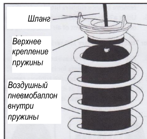
Рис. 2: Крепление пневмобаллона к пружине
